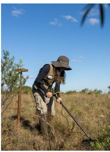
**Figura 8** – Equipe de Controle de Qualidade de Campo utilizando detector de metais para encontrar o marco de alumínio instalado pela equipe da empresa, visando avaliar a materialização do Ponto Central (2ª Etapa).
